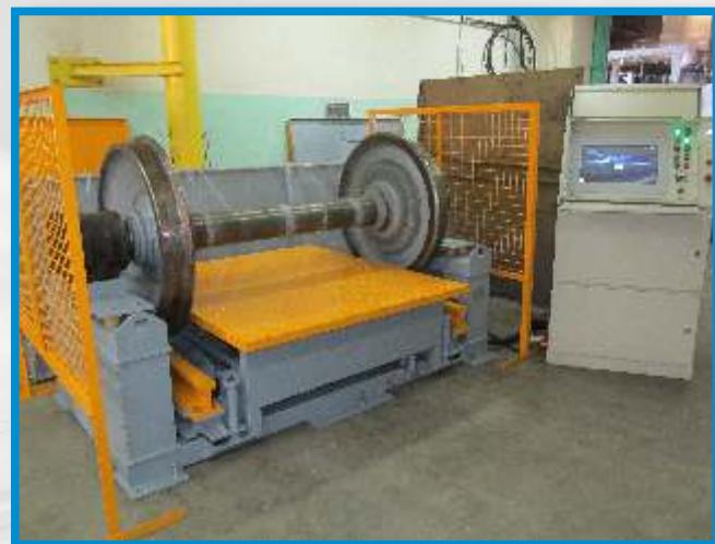
Комплекс имеет возможность создания базы данных всех проверяемых колесных пар. В базе данных содержатся: табельный номер дефектоскописта, номер проверяемой колесной пары, результат проверки (брак выявлен или брак не выявлен), дата проверки, время проверки. Проверка акустических шумов производится по обеим сторонам колесной пары одновременно.
