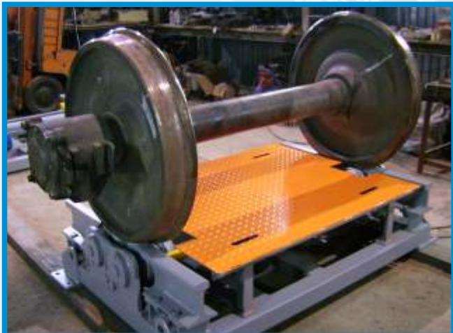
выталкивается с вращателя при помощи пневматического устройства для дальнейшего обслуживания.
